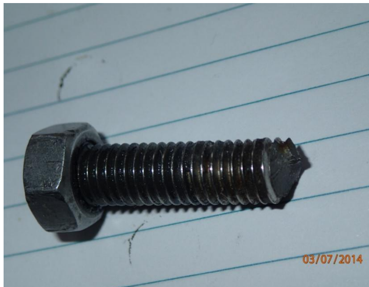
Original broken stud
